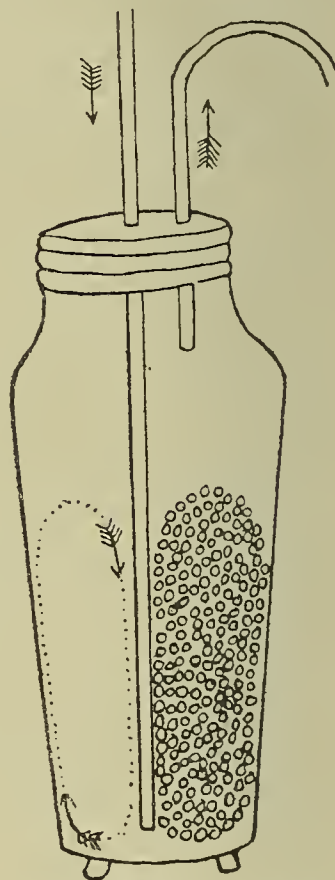
Рис. 161. Аппаратъ для развития оплодотворенной сиговой икры.
